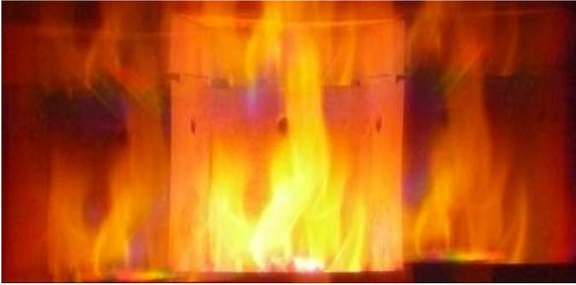
Bild 46: Übergang Vergasungsphase/Glutphase,  $\lambda = 2,6$ ,  $\text{CO}_{13\% \text{O}_2} = 0,11\%$ ,  $\eta = 79 \%$
