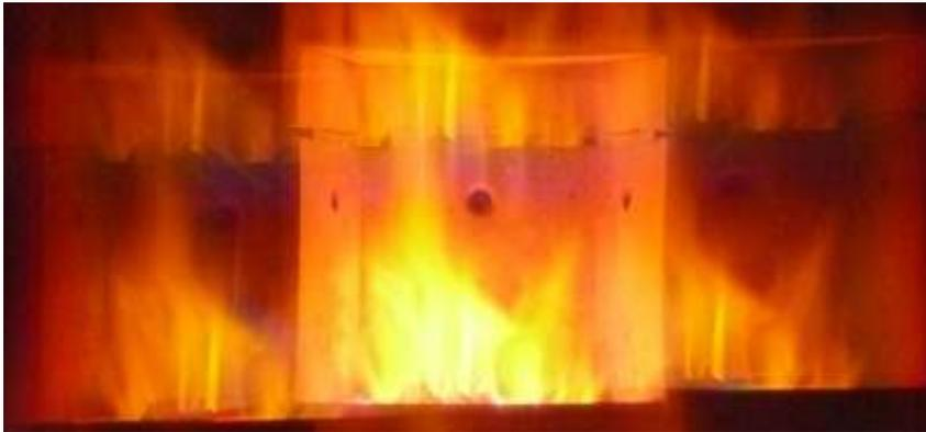
Bild 47: Glutphase,  $\lambda = 2,4$ ,  $\text{CO}_{13\% \text{O}_2} = 0,21\%$ ,  $\eta = 81 \%$
