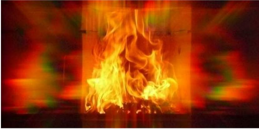
Bild 42: Entgasungsphase,  $\lambda = 1,7$ ,  $\text{CO}_{13\% \text{O}_2} = 0,1\%$ ,  $\eta = 81 \%$
