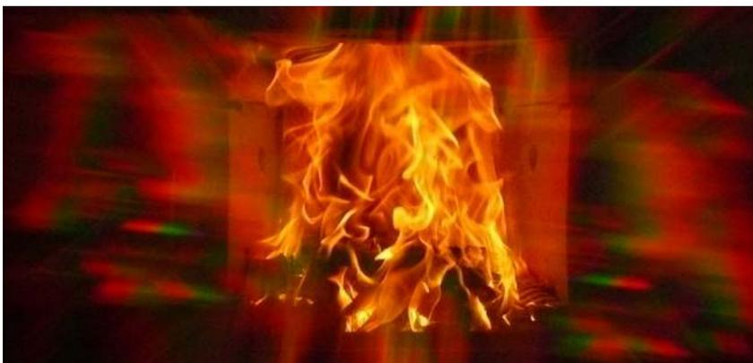
Bild 41: Entgasungsphase,  $\lambda = 1,8$ ,  $\text{CO}_{13\% \text{ O}_2} = 0,042\%$ ,  $\eta = 80,4 \%$
