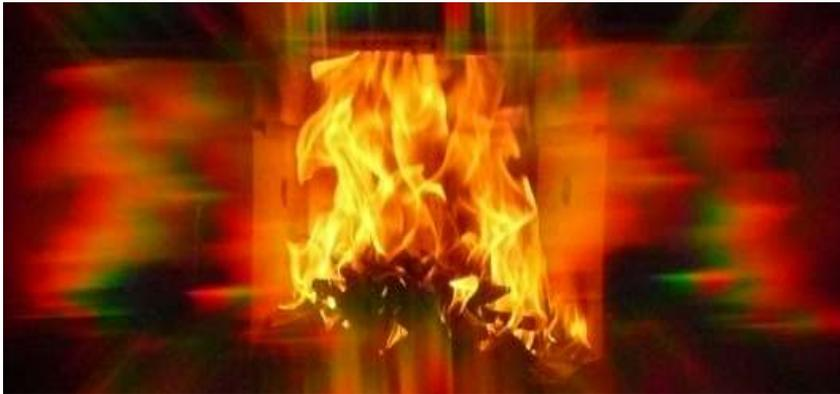
Bild 39: Entgasungsphase,  $\lambda = 2,8$ ,  $\text{CO}_{13\% \text{ O}_2} = 0,044\%$ ,  $\eta = 79 \%$
