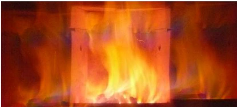
Bild 45: Vergasungsphase,  $\lambda = 3,4$ ,  $\text{CO}_{13\% \text{O}_2} = 0,06\%$ ,  $\eta = 75 \%$
