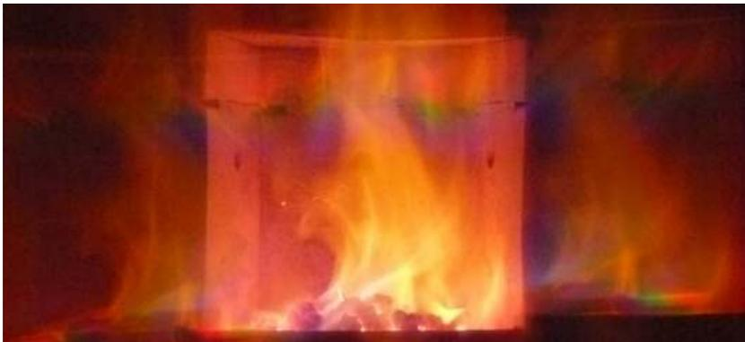
Bild 44: Vergasungsphase,  $\lambda = 2,6$ ,  $\text{CO}_{13\% \text{O}_2} = 0,22\%$ ,  $\eta = 77 \%$
